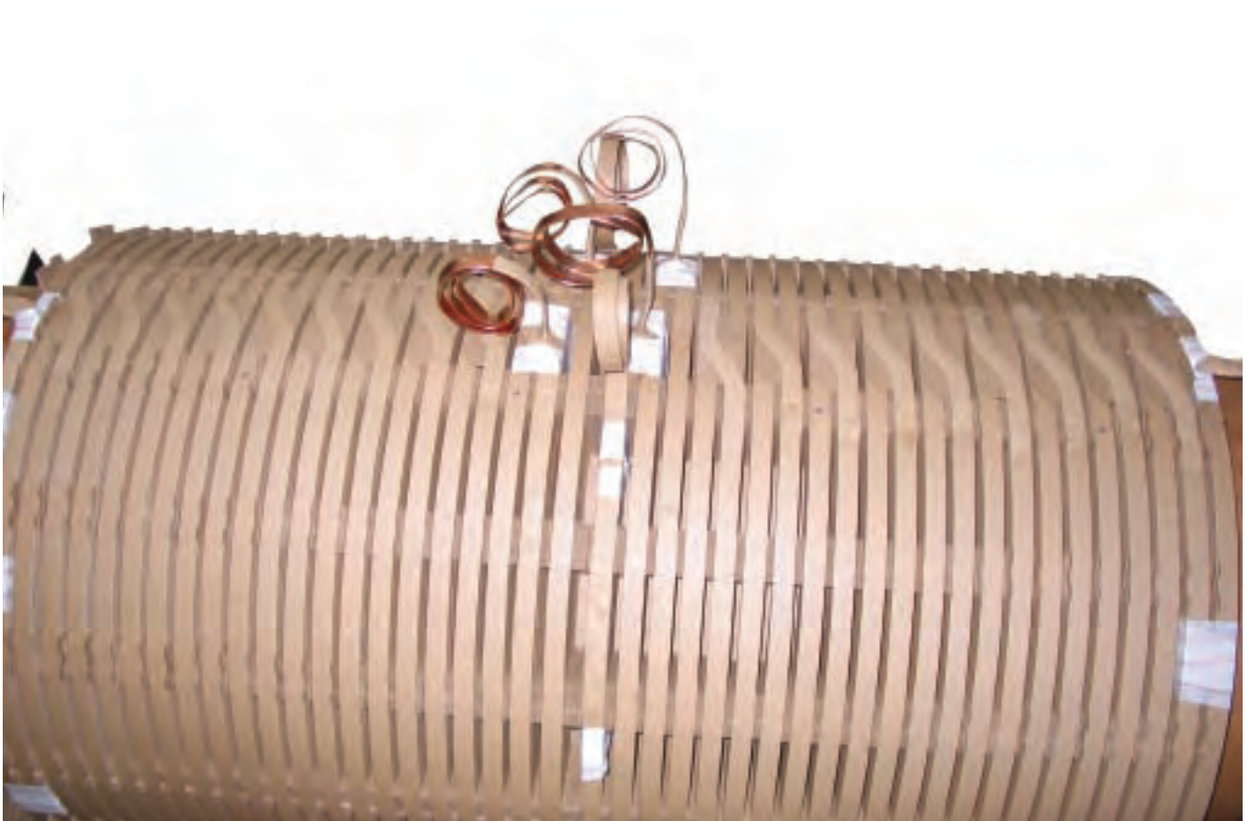
Devanado en disco con regulación en disco "interleaved". Transformador 12 MVA 45 kV \pm 2 \times 2,5\% Disc winding with interleaved disc regulation. Transformer 12 MVA 45 kV \pm 2 \times 2,5\%
