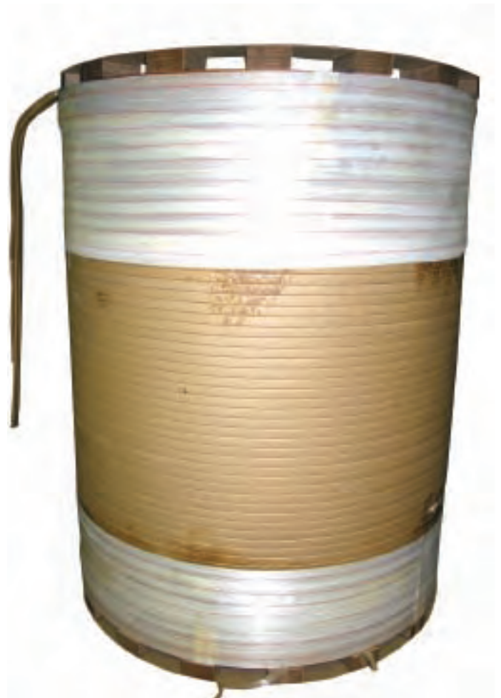
Devanado en hélice transformador 12 MVA 26.4 kV Helical Winding Transformer 12 MVA 26.4 kV
