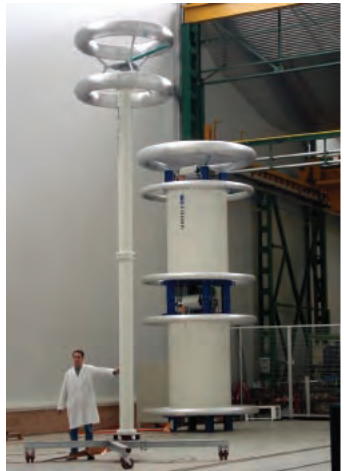
Equipo para ensayo de CA a frecuencia industrial Separate source AC withstand voltage test equipment
