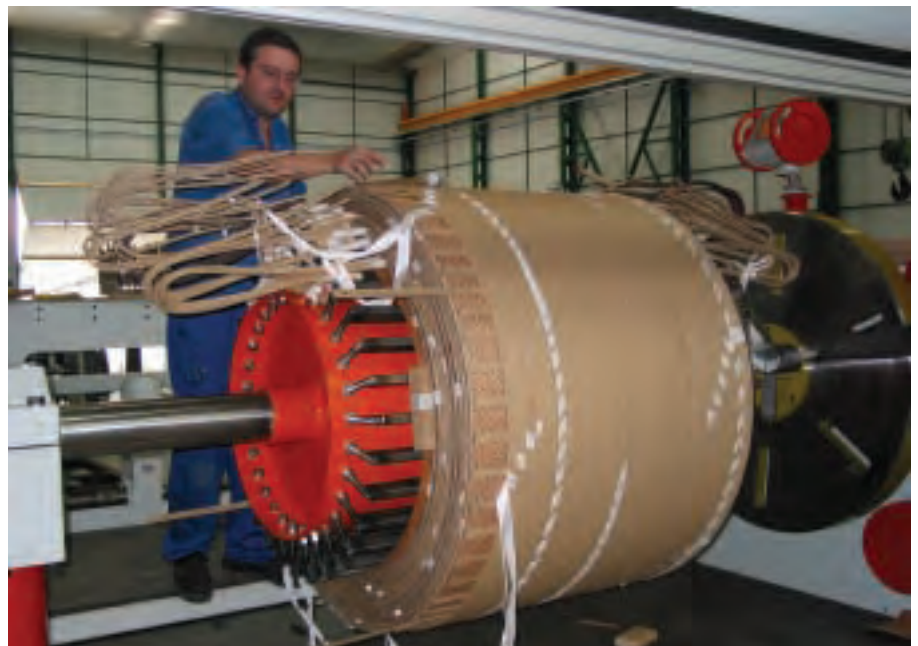
Devanado en capas transformador 40 MVA 66kV Layer windings Transformer 40 MVA 66 kV
