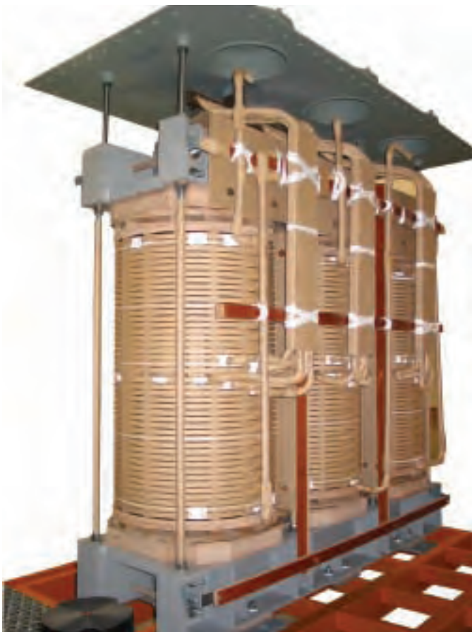
Parte activa transformador 16 MVA 45 kV \pm 2 \times 7,5\% . Devanado disco continuo con regulación
