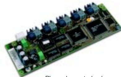
Placa de controlo de aplicações e motor.
