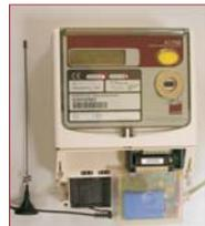
Os dados do contador podem ser lidos via porta óptica ou via módulos RS232 e RS485, ambos os módulos podem ser utilizados para as seguintes aplicações:
