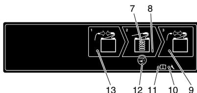
O sistema electrónico de carregamento SLT 100 supervisiona e controla o processo de carregamento. A indicação do processo de carregamento é feita por díodos luminosos (LED) (7). Um dispositivo de controlo electrónico reconhece o momento da formação de gases e determina o período ideal de recarregamento com base na capacidade de carga presente (balanço Ah).
