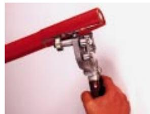
(\* ) Los cuchillos de las pinzas PF son intercambiables y elegidos en función del espesor de la cubierta.
