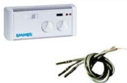
Características Técnicas: Alimentação: 230 V a.c. – 50/60 Hz; Potência Máx. Dissipada: 1,5 VA; Regulação: 5 a 25°C Intervalo diferencial: 1°C Assimétrico; Contacto Relé: 8(2)A, 250V a.c.; Temp. Utilização: 0-50°C Limite de humidade relativa: 0 – 90 RH% Não condensa; Grau de proteção: IP X0DCór: RAL 9001 UL 94; Carcaça envolvente: ABS
