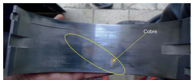
Figura 3. Exemplo de desgaste anormal de uma capa.
