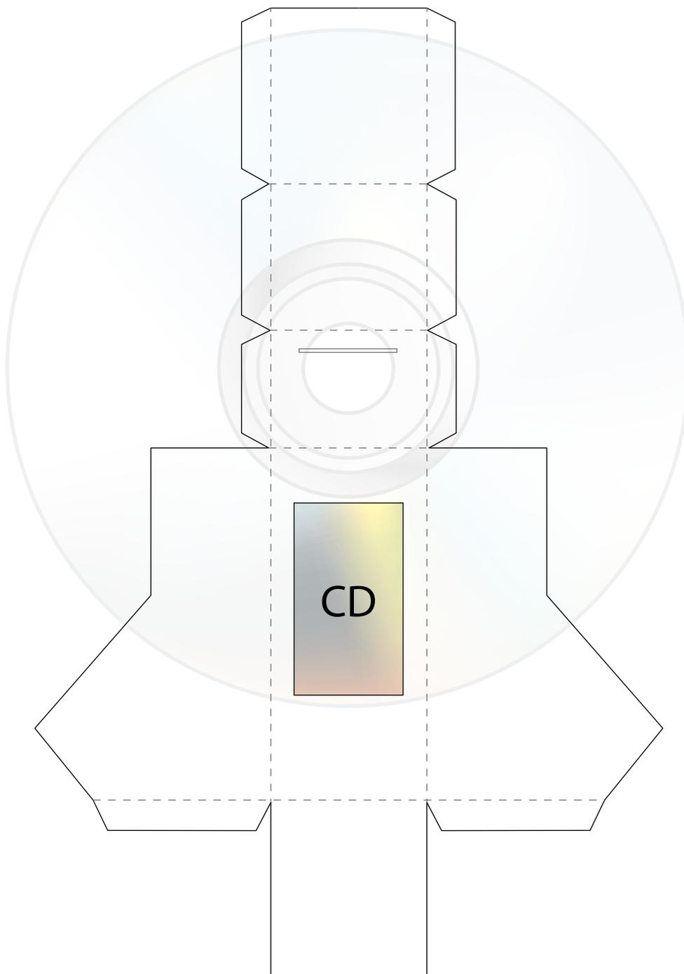
Construção de um espectrómetro recorrendo a um pedaço de CD, sendo este o elemento dispersor de luz, que funciona como uma rede de difração por reflexão.
