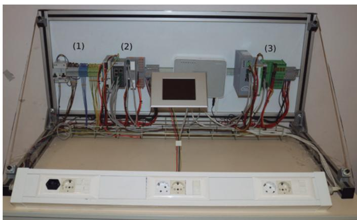
**Figura 5.** Protótipo do sistema. Legenda: (1) Alimentação AC (interruptor diferencial e disjuntor); (2) Subsistema do cliente: Fonte de alimentação 24 VDC; Switch Ethernet; PLC AXC CLOUDPRO; Painel de supervisão (TP3057Q); (3) Subsistema do fabricante: Fonte de alimentação 24 VDC; Switch Ethernet; ILC 130ETH; CLOUD COUPLER-PRO.
