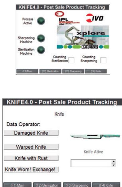
Figura 2. Interface gráfica com os operadores (Consola Phoenix Contact TP3057Q) – exemplos de ecrãs.
