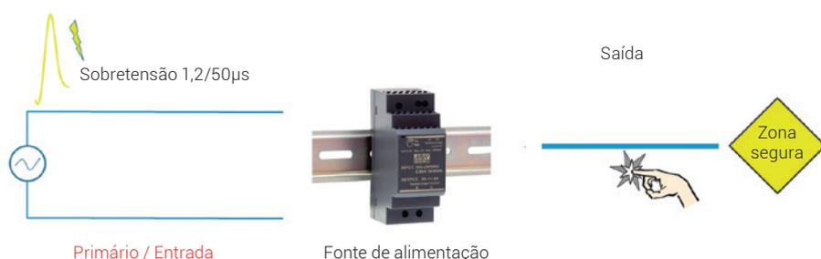
Figura 1. Proteção contra sobretensões para garantir segurança.
