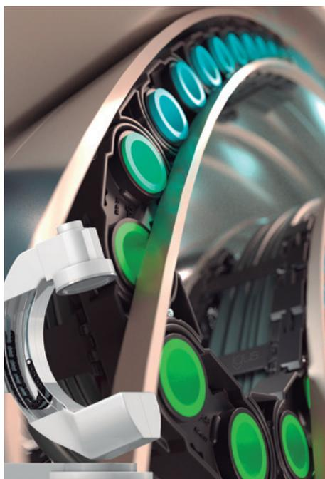
**Figura 1.** O princípio da lokchain: pernos automaticamente extensíveis (a azul) fixam a lokchain na guia. Quando o elo roda na curva, o pino retrai automaticamente (a verde) e solta a calha. Graças à sua flexibilidade, a calha articulada pode ser utilizada, por exemplo, em aparelhos de radiologia. (Fonte: igus GmbH)
