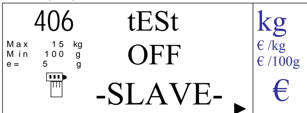
Todas las balanzas entran en un modo de test en el que se visualiza ‘TEST’ en el display de peso, ‘ONLINE’ u ‘OFF’, si se detecta o no actividad en el cable de comunicaciones y ‘MASTER’ o ‘SLAVE’ si la balanza tiene o no el máster de las comunicaciones.
