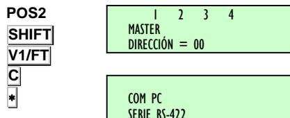
Una balanza ESCLAVA es que aquella que cada vez que tiene que realizar alguna operación, solicita los datos a la balanza maestra. En su respectiva maestra tendremos que elegir el tipo de comunicación entre maestra – esclava: *ETHERNET UDP* o *RS-485*. Esta configuración está en **posición 2**, pulsando **T/FT**, con la letra **C** conmutaremos entre los dos tipos de comunicación y con la tecla **\*** guardamos la configuración.
