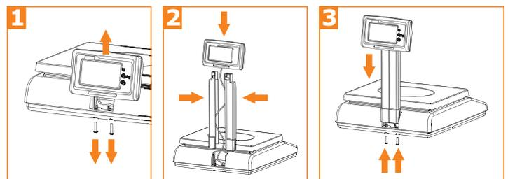
**La torre está incluida** en la caja de la balanza y puede ser instalada fácilmente por el propio usuario.
