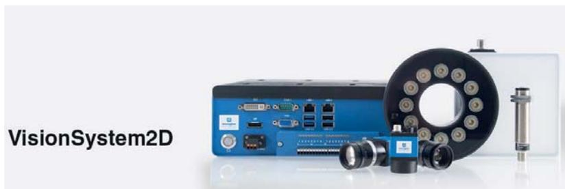
O novo VisionSystem2D da wenglor é um sistema modular de processamento de imagem que foi desenvolvido para todas as aplicações de visão. Consiste em até 16 câmaras digitais, lentes com várias distâncias focais fixas, equipamentos de iluminação externa e uma unidade de controlo (IPC), com todas as *interfaces* padrão comuns, bem como *software* para avaliação de imagens.
