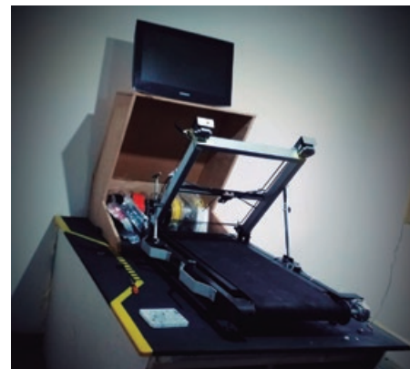
Figura 6. Protótipo impressora 3D - impressão infinita eixo Z com tapete rolante.
