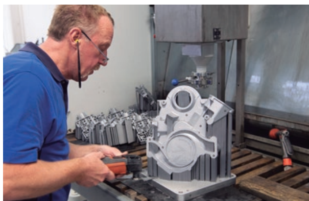
Figura 5. Remoção da placa de construção. GOM GmbH.
