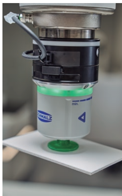
Figura 3. A Schmalz oferece soluções baseadas com tecnologia de vácuo, como o Handling-Set ECBPMi, para o manuseamento de peças pequenas.
