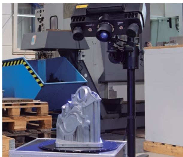
Figura 3. Medição da cobertura frontal antes do tratamento térmico e remoção da placa de construção. GOM GmbH.
