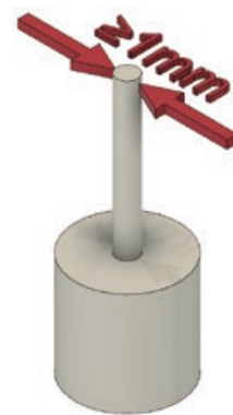
Figura 2. Diâmetro mínimo dos pinos.
