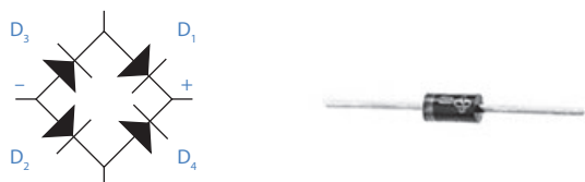
Figura 113. Esquema da Ponte de Graetz (esquerda) e diodo da série 1N4000 (direita). Fonte do diodo retificador: RS - https://pt.rs-online.com/ .
