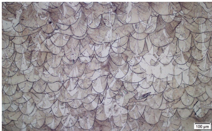
Figura 1. Microestrutura de uma peça em aço inoxidável 316L produzida por fusão seletiva por laser (ataque eletrolítico 6 V, 50 s com 10g de ácido oxálico e 90 ml de água destilada. Microscopia ótica com luz polarizada, fotografia de Tiago Leça, 2018).
