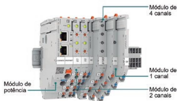
Figura 3. Módulos de disjuntor eletrônico de 1, 2 e 4 canais e módulo de potência.
