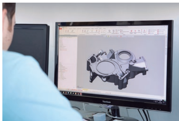
Figura 2. Engenharia inversa da antiga tampa frontal do Cadillac Eldorado de 1967. GOM GmbH.
