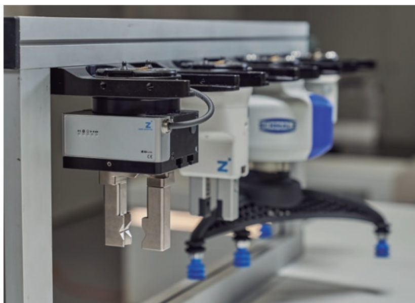
Figura 1. MATCH – Novo ecossistema End of Arm do Zimmer Group e da Schmalz com um vasto pacote de funções e interfaces universais.
