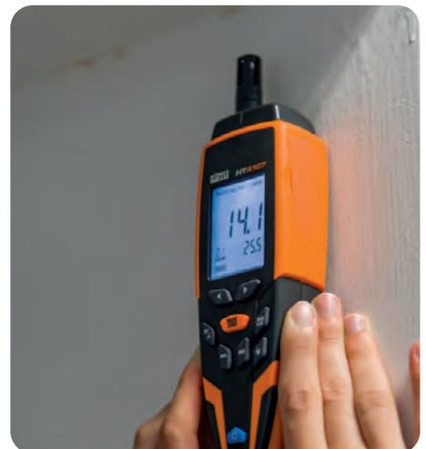
Medição de humidade em materiais com sensor integrado do HTA 107 (Foto: medição direta numa parede aparentemente húmida)
