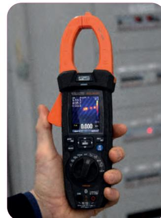
Verificação termográfica com ponteiro laser
