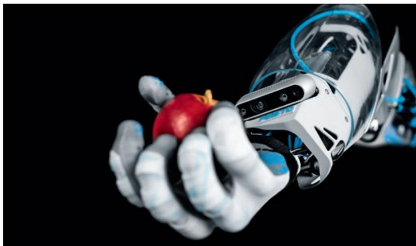
Todo o sistema, desenvolvido em colaboração com a ETH Zurich, possui um *design* modular e consiste em 3 subsistemas: um *robot* móvel, um braço de *robot* elétrico e o BionicSoftHand 2.0. A pinça pneumática, apresentada pela Festo em 2019, é inspirada na mão humana.
