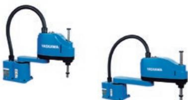
A Yaskawa aumentou o seu portefólio de produtos com os novos MOTOMAN SG400 e MOTOMAN SG650. Estes foram projetados para cargas úteis de até 3 e 6 kg, respetivamente, e cobrem uma faixa de trabalho de 400 e 650 mm. São, portanto, particularmente adequados para aplicações que exigem alta velocidade e grande precisão.
