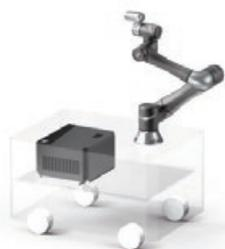
A série móvel TM-M da Techman Robot, composta pelas versões TM5M-700, TM5M-900, TM12M-1300 e TM14M-1100, são alimentados a 20-60V DC, tornando-os compatíveis com a maioria das marcas de AGVs e outros veículos móveis. Através do uso dos “TM – Landmark”, os robots móveis podem orientar-se num espaço 3D, como uma sequência de dados automática, para servir várias máquinas. Isto permite que os TM-M possam operar entre duas ou mais posições sem problemas.
