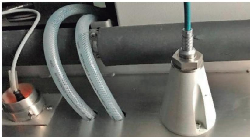
Figura 3. Máquina de limpeza de peças na Thyssenkrupp. A concentração do meio de limpeza é medida usando o Teqwave I embutido.
