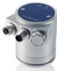
O encoder ISA 698 com válvula GORE-TEX foi desenvolvido pela Leine Linde, originalmente para plataformas de perfuração de rochas na indústria mineira. A nova válvula GORE-TEX permite evitar que a humidade se acumule dentro do encoder, possibilitando a libertação unidirecional da humidade por forma a manter o interior do encoder seco, para um funcionamento ótimo.
