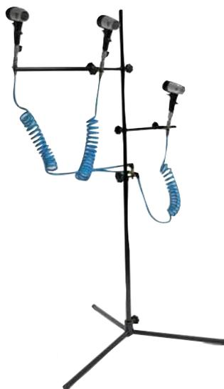
Estación fácilmente regulable en altura y en anchura para posicionar de manera sencilla las pistolas Tornado 7000 en función del tamaño de la pieza a secar.
