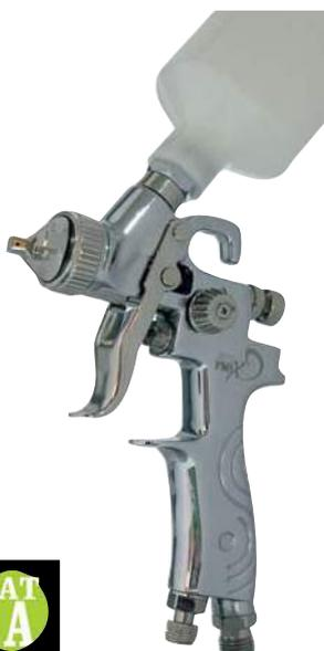
Boquilla sistema aerográfico de altísimos acabados. Pico y aguja 100% inox. Regulador de abanico lateral. Regulador de producto con contratuerca. Válvula avanzada 0% fugas. Cuerpo níquelado muy ligero y ergonómico de aluminio estampado. Regulador de caudal de aire integrado en el cuerpo..
