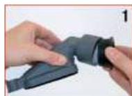
Colocar el adaptador de goma del Bohrfixx-Conectar la manguera del aspirador al Bohrfixx
