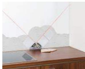
**Láser para alicatados.** Proyecta dos líneas láser perpendiculares (90°), hasta 7 m. Para uso con baldosas en horizontal y diagonal. Incluye base de fijación a pared, 2 baterías tipo AA(1,5 v). Tiempo de trabajo >15 h, class 2<1 mw, rango 7 m. precisión 0,5 mm, peso 115 grs, medida 160x84x84 mm.
