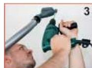
Conectar el aspirador y colocar el Bohrfixx en el lugar deseado.
