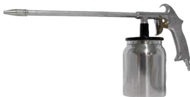
Boquilla con función de soplado y regulador de producto. Cuerpo de aluminio excelente calidad y acabado. Empuñadura ergonómica. Depósito de aluminio de 750 cc.
