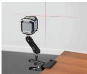
Proyecta simultáneamente una línea vertical y una horizontal. Se auto alinea en menos de 5 segundos. Con mordaza de fijación. Incluye mordaza de fijación, 2 baterías AAA (1,5v.). Tiempo de trabajo >15 h, class 2<1 mw, rango: 10 m, precisión +/- 0,5 mm/m, tiempo de auto nivelación <5 seg, peso: 162 gr, medida: 65x65x56 mm.
