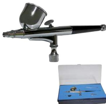
Modelo de aerógrafo de mecánica tradicional. Sistema de alimentación por gravedad con copa fija de 5 cc. Gatillo de doble acción. Control de la cantidad de aire y producto. Tornillo retén trasero que limita el movimiento del gatillo y con ello el ancho máximo del pulverizado y de la cantidad de producto.
