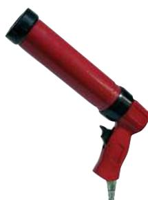
Pistola neumática para cartuchos estándar de siliconas, selladores, etc. Función de despresurización al soltar el gatillo. Presión máx. de trabajo 2 bar. Fabricada en aluminio.
