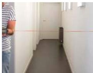
**Telémetro láser digital.** Útil para medición de distancias hasta 60 m. con una precisión de 2 mm. Calcula áreas y volúmenes. Permite medidas indirectas (medida pitagórica). Incluye 2 baterías AAA(1,5 v.). class 2<1 mw. rango:60 m, precisión +/-2.0 mm, peso: 105 gr. medida:52,80x127x26,30 mm.
