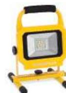
Foco Led portátil recargable 20 w con carcasa e aluminio orientable a 120°. 3 niveles de brillo y función SOS. Tiempo de carga 3,5 h. Horas de trabajo de 2,5 a 6 h. 1800/900/450 lumens. Color temperatura 6500 k. Protección IP44. Batería 7,4 Li-Ion-5200 mAh.
