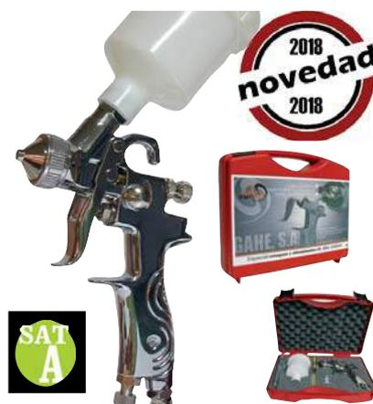
Boquilla sistema aerográfico de altísimos acabados. Pico y aguja 100% inox. Regulador de producto con contratuercas. Válvula avanzada 0% fugas. Cuerpo níquelado muy ligero y ergonómico de aluminio estampado. Regulador de caudal de aire integrado en el cuerpo.
