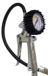
Manómetro de 0 a 12 bar, latiguillo de 43 cm. Gatillo con posición de verificado, inflado y desinflado. Cuerpo de aluminio niquelado.
