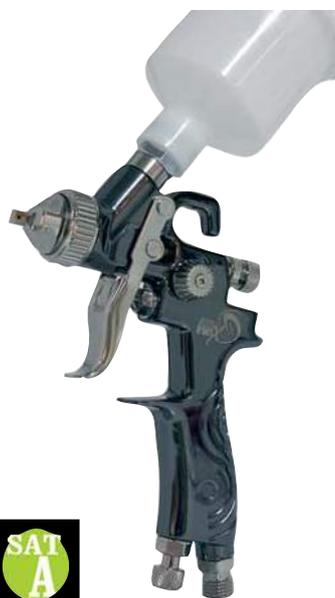
Boquilla sistema HVLP de altísimos acabados. Pico y aguja 100% inox. Regulador de abanico lateral. Regulador de producto con contratuerca. Válvula avanzada 0% fugas. Cuerpo de aluminio anodizado en negro muy ligero y ergonómico. Regulador de caudal de aire integrado en el cuerpo.
