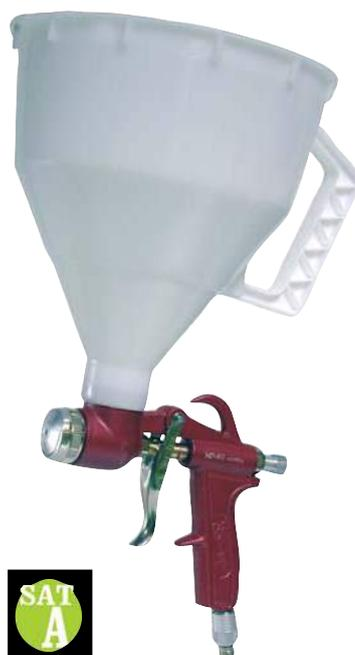
ESPECIAL APLICACION AISLANTES DE CORCHO. Boquilla especial revestimientos y aislantes de corcho de 6 y 8 mm. Tratamiento exterior antiadherente teflonado metálico de alta duración. Cuerpo inyectado de aluminio. Regulador de producto. Depósito de nylon 5 l. **Válvula de cierre de aire en la MP 8 R VÁLVULA**
