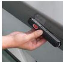
**Nivel de burbuja láser.** Proyecta una línea de 3 m, o un punto fijo sobre una pared, para un equilibrado o nivelado perfecto. El láser se adapta fácilmente al soporte magnético. Operación con un único botón. Incluye soporte de pared, 2 baterías AAA 1,5 v., tiempo de trabajo >15 h, class 2<1 mw, rango: línea 3 m, puntero 20 m, precisión 1 mm/m, peso 103 gr. medida: 165x23x33,5 mm.
