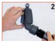
Conectar la manguera del aspirador al Bohrfixx
