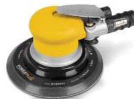
**Lijadora orbital de aire.** 6,3 bares. Caudal de aire 240 l/m. Superficie de lijado 150 mm.
