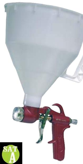
Boquilla especial gotelé de 4,5 y 6 mm. Depósito de nylon de 5 l. Regulador de producto. Cuerpo de aluminio inyectado, con tratamiento exterior antiadherente. Regulador de caudal de aire.
