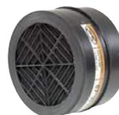
Filtro químico compuesto de carbón activo que protege ante compuestos a base de esmaltes, barnices vítreos, lacas, pinturas, vapores orgánicos e inorgánicos y gases ácidos. No utilizar en ambientes con una concentración menor al 17% de oxígeno
