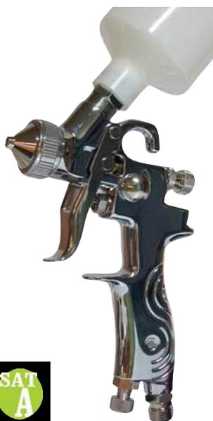
Boquilla sistema aerográfico de altísimos acabados. Pico y aguja 100% inox. Regulador de producto con contratuerca. Válvula avanzada 0% fugas. Cuerpo níquelado muy ligero y ergonómico de aluminio estampado. Regulador de caudal de aire integrado en el cuerpo..
