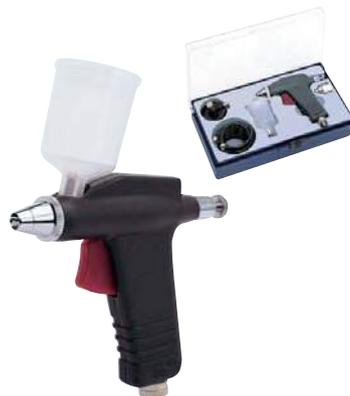
Con empuñadura ergonómica y gatillo, más cómodo para trabajos prolongados. Un aerógrafo «TODO TERRENO» igualmente útil en trabajos de gran ancho de pulverizado como en los de trazo fino y preciso. Tornillo retén trasero que limita el movimiento del gatillo y con ello el ancho máximo del pulverizado y de la cantidad de producto.
