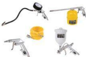
**Set accesorios compresor básico.** Pistola de inflado 8 bares caudal<283 l/m. Pistola pintura 4 bares, depósito de 600 cc. y caudal 142 l/m.. Pistola de aire 6 bar caudal<170 l/m. Manguera espiral 5 m. diam 5x8 mm. Pistola de lavado, depósito 900 cc. 4 bar y caudal<170 l/m.
