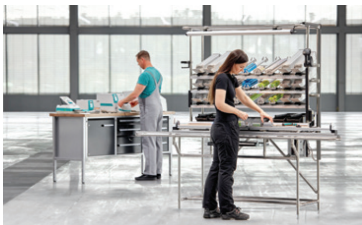
Figura 1. A montagem de platines a montante com a subsequente fixação de réguas de bornes em calhas DIN pré-montadas oferece um potencial significativo para aumentar a eficiência na construção de quadros de controlo.
