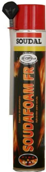
Espuma de PU retardante ao fogo até **240 minutos** (EN 1366-4). Indicada para a colagem e montagem de janelas e portas corta-fogo, todas as selagens retardantes em ligações entre elementos da construção, todas as aberturas em telhados, isolamentos térmicos, entre outros. Existe também com aplicação em pistola.
