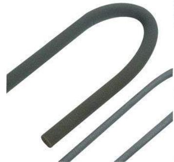
Fundo de Junta PU é um perfil redondo feito de Espuma de Polietileno, que é utilizado como não adesivo de enchimento em todas as juntas de construção e para assegurar a correcta dimensão das juntas de selantes. Adequado como material de enchimento para todo o tipo de selantes (silicones, PU, Polissulfeto, Acrílicos, MS Polímeros).
