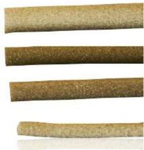
Perfil redondo de células fechadas de polietileno, que são utilizadas como não adesivos de enchimento em todas as juntas de construção e para assegurar a correcta dimensão das juntas de selantes. Adequado como material de enchimento para todo o tipo de selantes (silicones, PU, Polissulfeto, Acrílicos, MS Polímeros).
