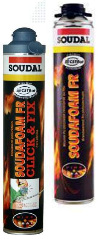
Espuma de PU retardante ao fogo até **240 minutos** (EN 1366-4), para Pistola e no sistema Click & Fix. Indicada para a colagem e montagem de janelas e portas corta-fogo, todas as selagens retardantes em ligações entre elementos da construção, todas as aberturas em telhados, isolamentos térmicos, entre outros.
