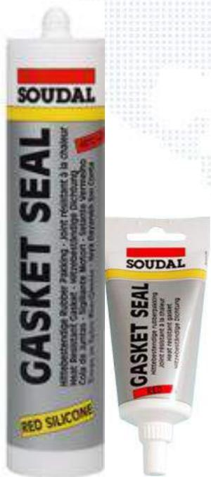
Selante elástico à base de silicões que resiste a temperaturas elevadas. Específico para a colagem de **peças metálicas**, de sistemas de aquecimento e de maquinaria de cozinha. Indicado também para a montagem de juntas de culatra em bombas e motores, dada a sua resistência a elevadas temperaturas.
