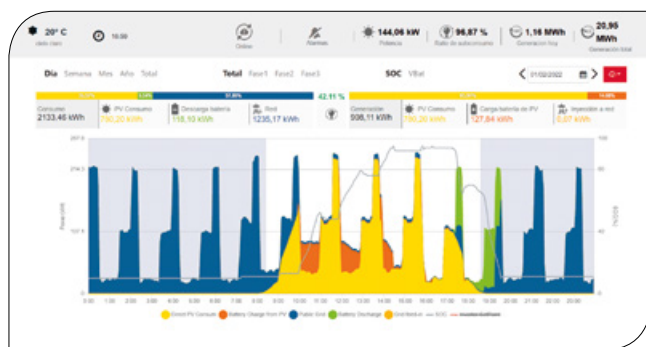
Figura 3 Imagem diária de monitorização de energia do central solar com acumulação. Imagem do portal Ingecon Sun Monitor.
