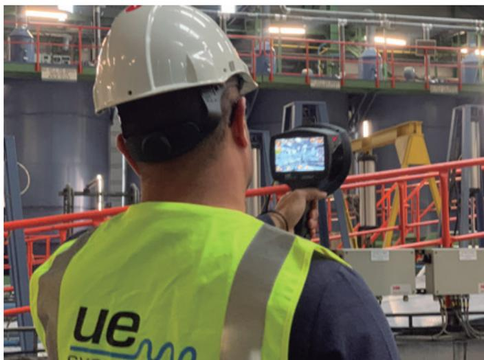
Depois de realizarmos cerca de 60 auditorias de fugas em diferentes instalações de diferentes indústrias, utilizando uma câmara de ultrassons, concluímos que uma fuga de ar, em média, custaria cerca de 1200€ por ano. Se pensarmos que qualquer instalação industrial terá dezenas ou mesmo centenas de fugas, rapidamente nos apercebemos do potencial de poupança.
